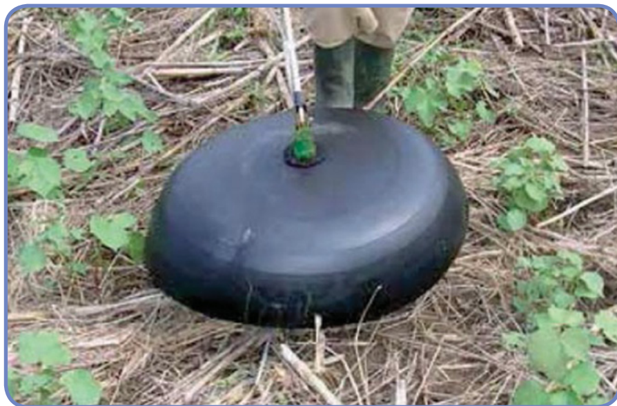
Рис. 25 Защитное приспособление на ранцевый опрыскиватель для предотвращения попадания рабочего раствора на растения
