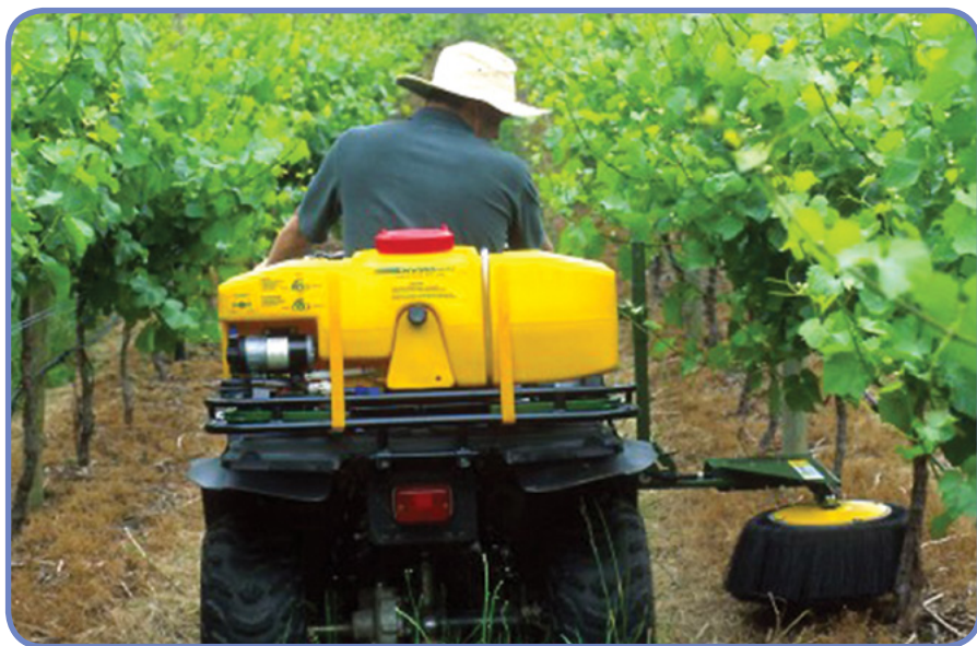
Рис. 26 Защитное приспособление на механизированный опрыскиватель для предотвращения попадания рабочего раствора на растения
